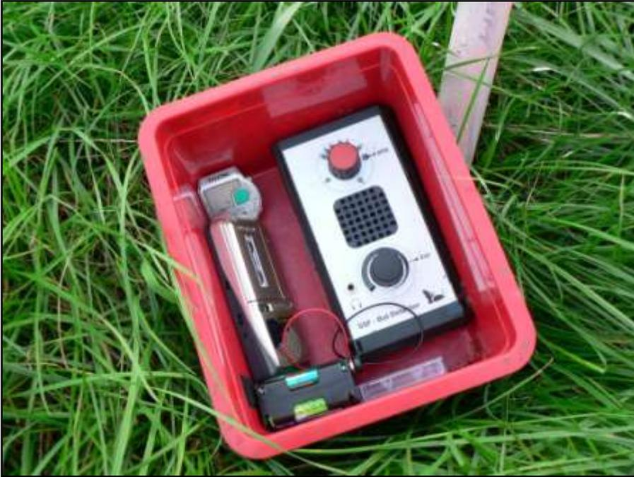
Abbildung 3: Beispiel für den Aufbau einer Horchkiste
