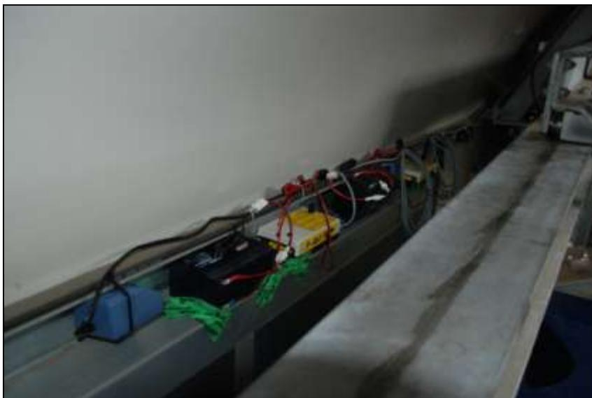
**Abbildung 5: Aufbau des AnaBat-Systems im Inneren der Gondel der WEA des Typs Vestas V80**
