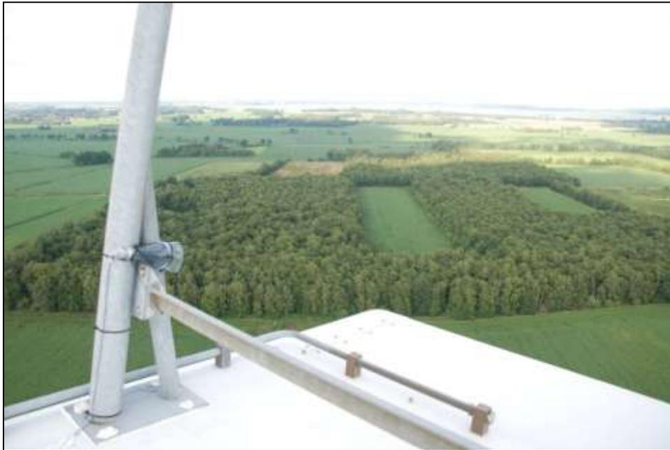
**Abbildung 4: Mikrofonposition des AnaBat-Systems auf dem Gondeldach der WEA des Typs Vestas V80**
