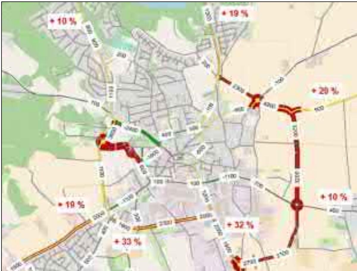
**Abbildung 39:** Verkehrsmengenentwicklung 2018 bis 2030, zentraler Stadtteil - Gesamtverkehr DTV [Kfz/24h]
