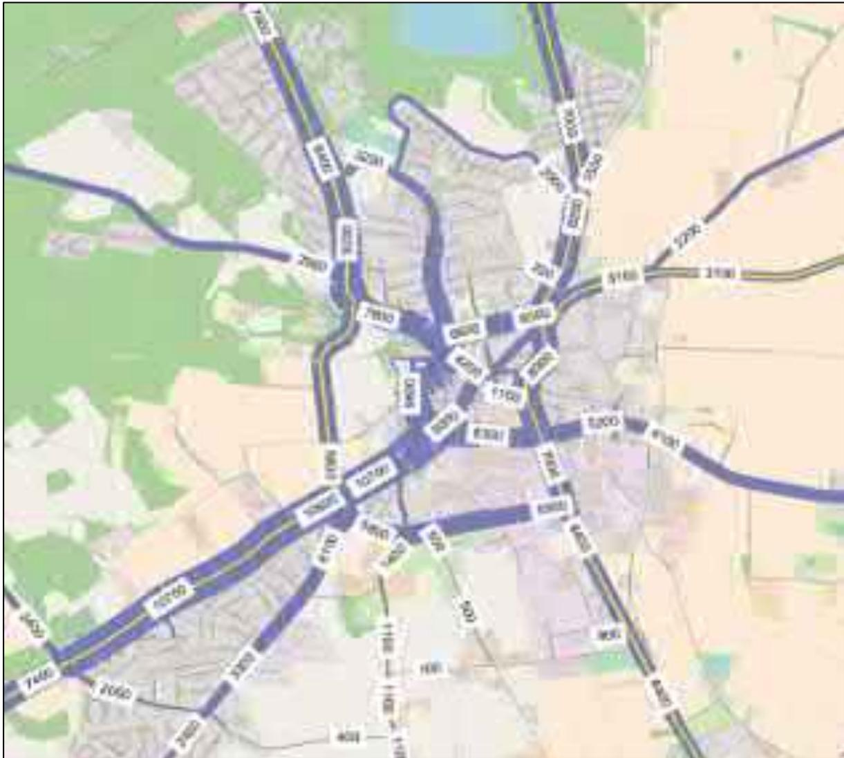
**Abbildung 15:** Verkehrsmengen 2018 zentraler Stadtteil – Gesamtverkehr DTV [Kfz/24h]
