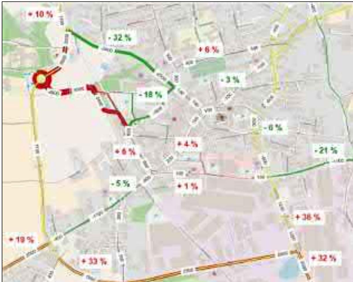
**Abbildung 41:** Verkehrsmengenentwicklung 2018 bis 2030, zentraler Stadtteil - Gesamtverkehr DTV [Kfz/24h]
