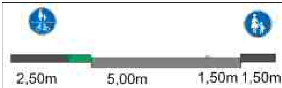
**Abbildung 75:** mögliche Querschnittsaufteilung in der Lindenstr.
