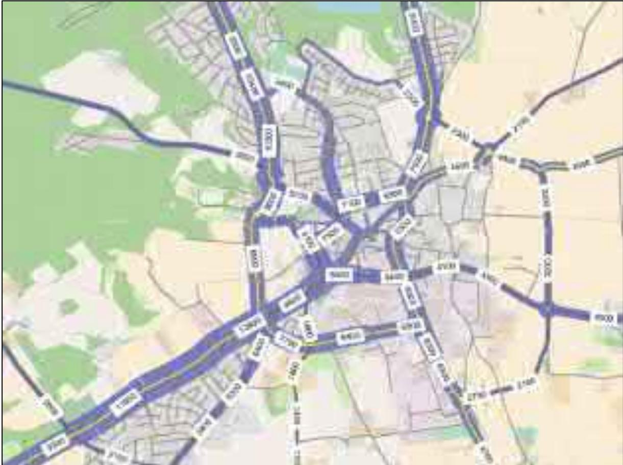
**Abbildung 38:** Verkehrsmengen Prognose 2030, Netzfall 0, zentraler Stadtteil – Gesamtverkehr DTV [Kfz/24h]
