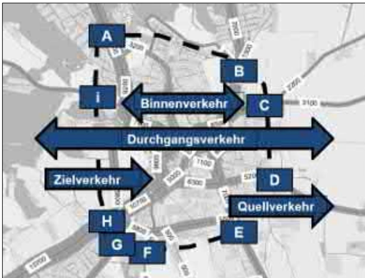
**Abbildung 18:** Definition Durchgangsverkehr
