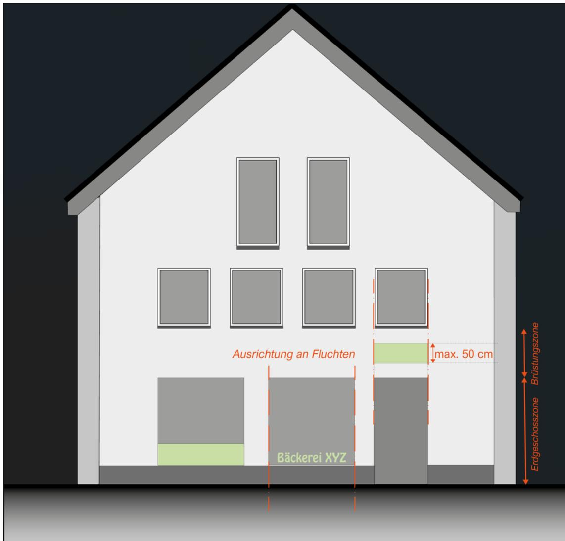
Abbildung 4: Schematische Darstellung des Fluchtbezugsgebotes, Quelle: eigene Darstellung
